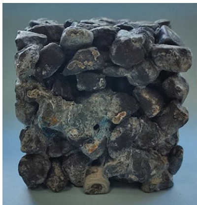
Rys. 2. Kostka o wymiarach 10x10x10 cm wykonana z kruszywo w granulacji do 30 mm z zastosowaniem spoiwa termoplastycznego na bazie odpadów poliolefinowych
