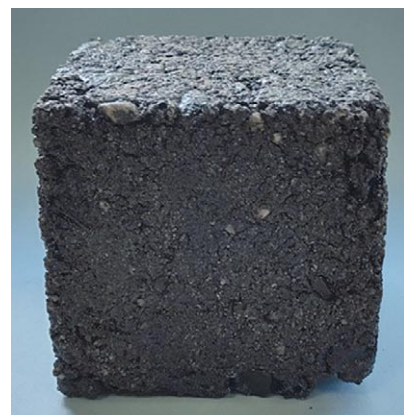
Rys. 1. Kostka o wymiarach 10x10x10 cm wykonana z kruszyw o granulacji do 16 mm z zastosowaniem spoiwa termoplastycznego na bazie odpadowego polistyrenu
