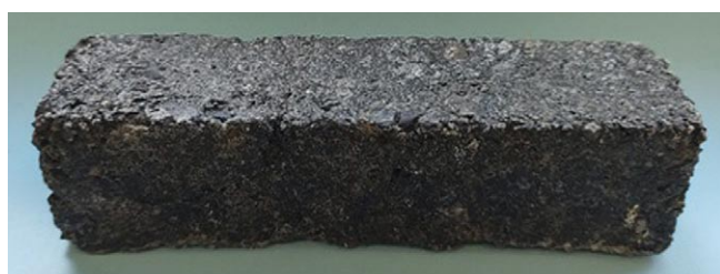
Rys. 3. Kształtka wykonana na bazie żwiru o granulacji do 6 mm z zastosowaniem spoiwa termoplastycznego pochodzącego z odpadów komunalnych oraz dodatku zbrojenia rozproszonego w postaci przemiału odpadowych włókien poliestrowych
