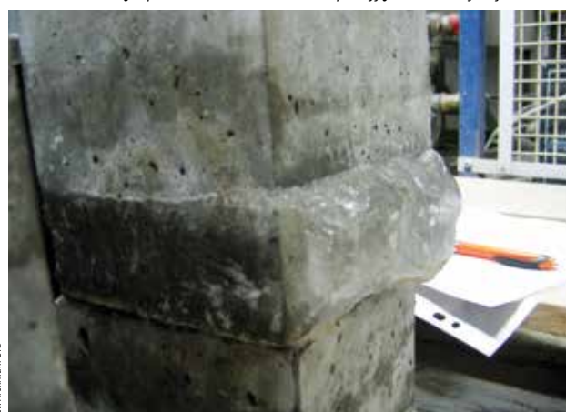
Fot. 6. Zamarznięta próbka betonowa do badań po wyjęciu z komory dojrzewania
