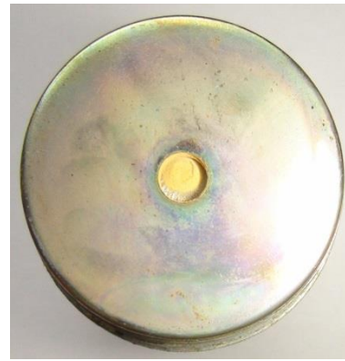
Fot. 2. Wypylony materiał wybuchowy wewnątrz kanału ogniowego w główce zapalnika artyleryjskiego [7]
