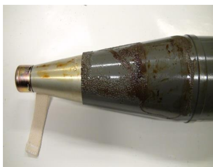
Fot. 3,4. Głowica pocisku odłamkowego z wyciekającą cieczą przed i po odkręceniu zapalnika [7].
