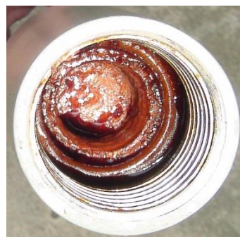
Fot. 3,4. Głowica pocisku odłamkowego z wyciekającą cieczą przed i po odkręceniu zapalnika [7].
