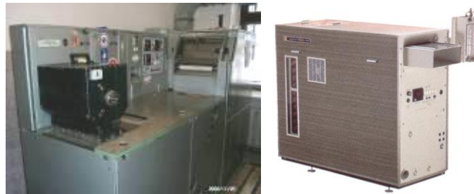
Rys.4. Procesory do obróbki filmów lotniczych. A. PM-32 /rosyjski/ B. VERSAMAT /Kodak/
