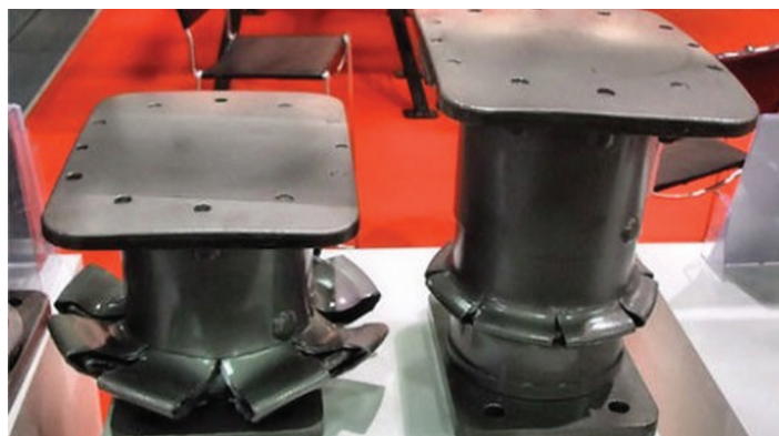
Fot. 1. Przykład zastosowania technologii umożliwiającej plastyczną deformację zderzaka kolejowego [10]
