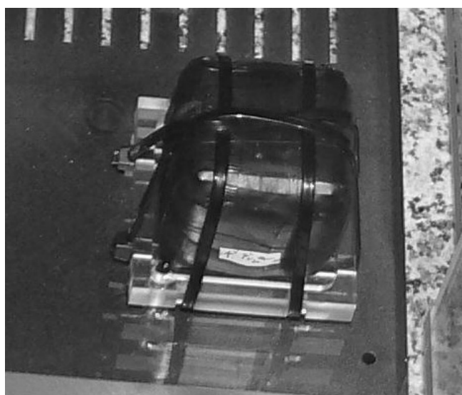
Rys. 5. Cewka generacyjna do generacji pola magnetycznego 3D Fig. 5. Coil for generation of 3D magnetic field
