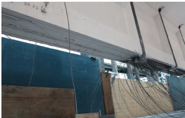
Rys. 9. Widok zerwanych taśm kompozytowych, powstrzymany przez oploty mat CFRP
