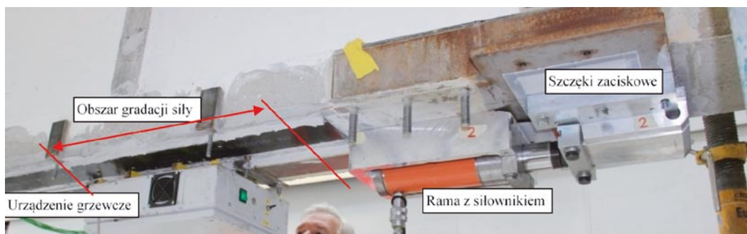
Rys. 4. Schemat wzmocnienia z widokiem urządzeń sprężających
