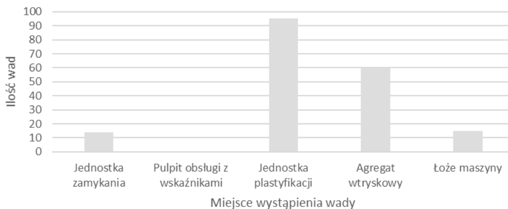
Rys. 16.2 Ilości awarii wtryskarki w zależności od miejsca wystąpienia
