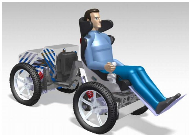
Rys. 11. Wizualizacja wózka inwalidzkiego wysokiej mobilności wraz z kierowcą
