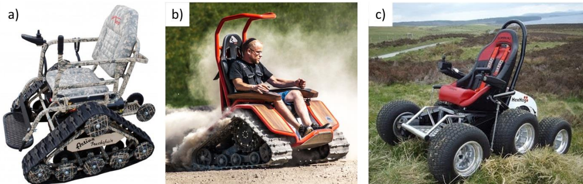
Rys. 2. Przykłady wózków inwalidzkich z napędem a) Action Track Chair [4], b) Ziesel [5], c) HexHog [6]
