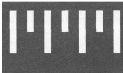
Rys. 5. Znak drogowy P-25 „próg zwalniający” malowany na jezdni
