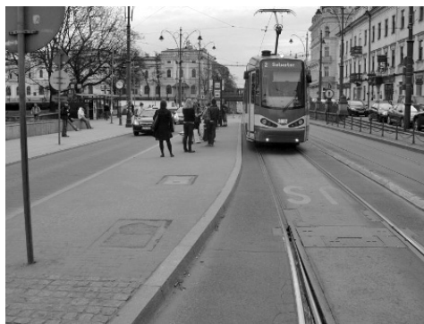
Fot. 14. Przystanek „Dworzec Główny” w kierunku centrum – samochody osobowe przejeżdżają przez wyniesioną jezdnię podczas możliwej wymiany pasażerskiej
