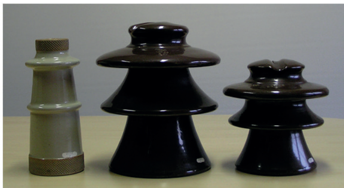
Rys. 2. Izolatory kamionkowe VHD20, VHD30 i izolator wewnętrzny. Kolekcja izolatorów laboratorium wysokich napięć Politechniki Wrocławskiej
