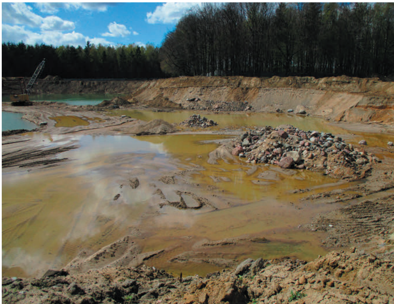
Fot. 1. Kopalnia Warcz VI podniesiony poziom wody w wyrobisku Fot. 1. Warcz VI mine - raised water level in the excavation
