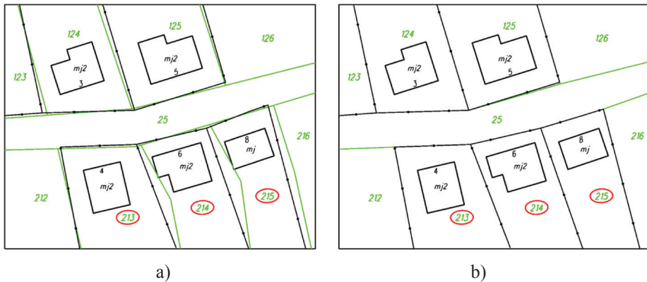
Rysunek 1. Fragment mapy ewidencyjnej powstałej na bazie mapy w skali 1:2000, a) przed modernizacją, b) po modernizacji.
