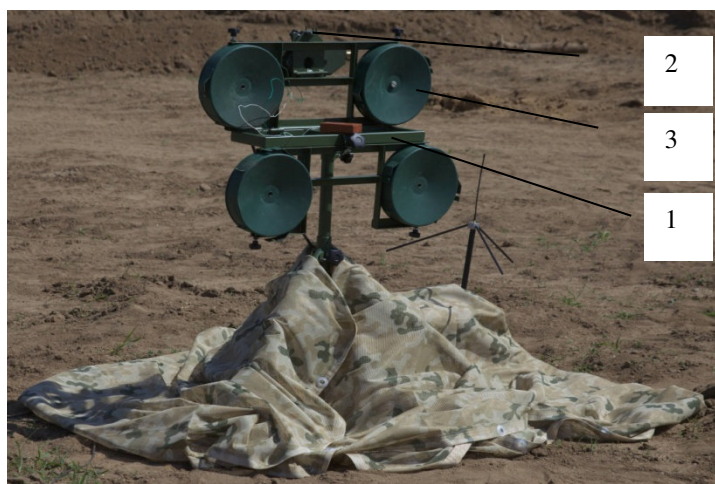
Rys. 4. Widok prototypu zestawu ładunków wybuchowych wąskiego rażenia SŁW/WR ustawionych i zamaskowanych w terenie (widoczne wysunięcie dolnej pary ładunków względem górnej): 1 – stojak; 2 – celownik; 3 – ładunek wybuchowy odłamkowego rażenia z miny MON-100
