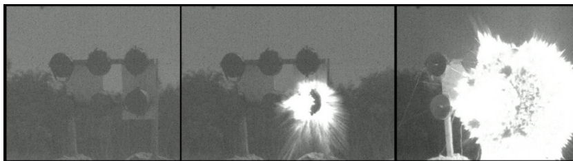
Rys. 2. Rejestracja niejednoczesnej detonacji ładunków wybuchowych odłamkowego rażenia z miny MON-100
