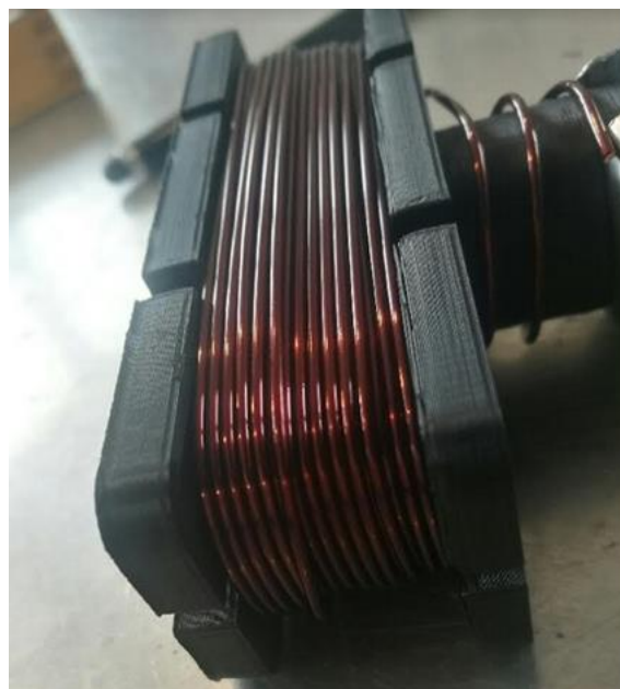
Rys. 3. Przykładowa cewka próbna uzwojona w Sieci Badawczej Łukasiewicz KOMEL
