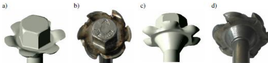
Rys. 2. Ukształtowany łeb śruby z wyplýwką: a, c – model numeryczny, b, d – rzeczywisty [6]
