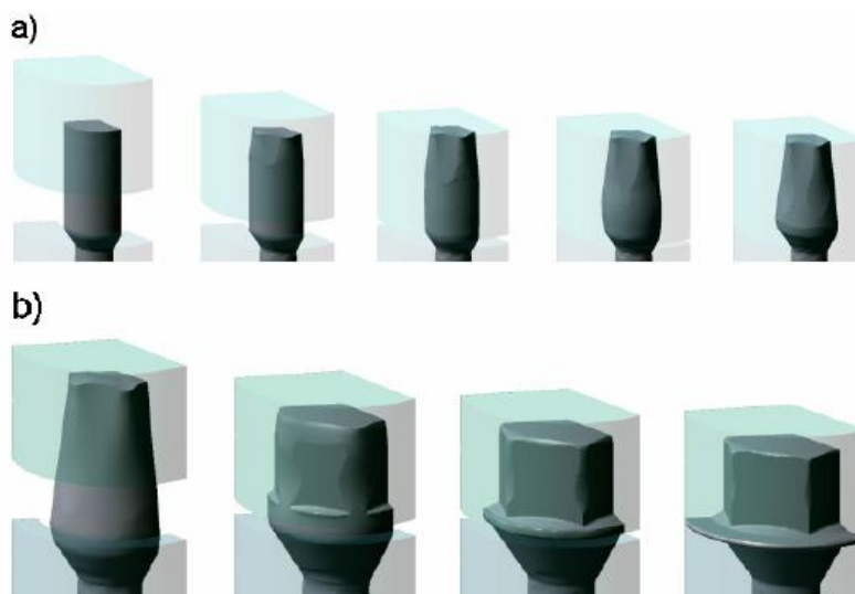
Rys. 3. Przykładowy przyjęty wariant pokazujący etapy wyciskania przedkuwki (a), matrycowania łba (b) [6]
