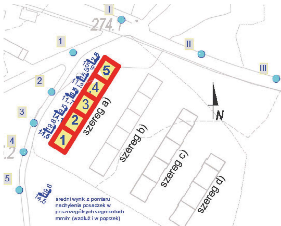
Rys. 1. Usytuowanie omawianego szeregu (oznaczenie segmentów od 1 do 5) wraz z naniesionymi punktami linii pomiarowych oraz wynikami pomiarów nachylenia posadzek w poszczególnych segmentach z 05.2016 r. (Praca ... 2016).
