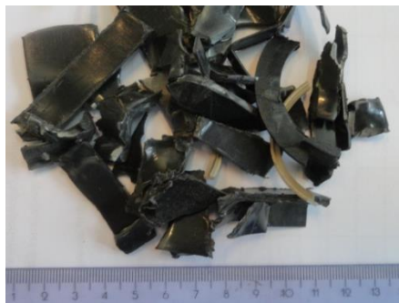
Rys. 2. Odpady polimerowe wysegregowane ze strumienia komunalnego (fot. M. Czop)
