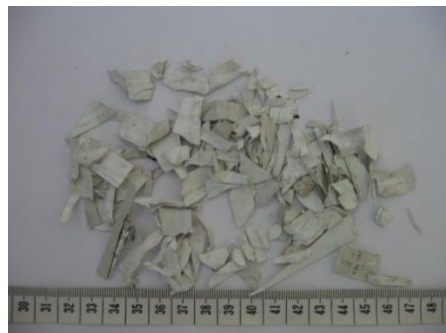
Rys. 2. Odpady polimerowe wysegregowane ze strumienia komunalnego (fot. M. Czop)
