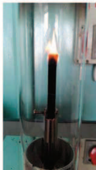
Rys. 7. Wartości indeksu tlenowego dla polipropylenu (PP), z napełniaczem w postaci włókna szklanego 30% (PP GF30), 40% (PP GF40) oraz próbka podczas spalania w kominie do badań
