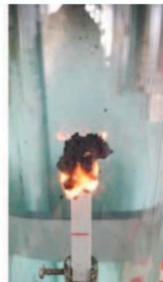
Rys. 8. Wartości indeksu tlenowego dla polipropylenu (PP), z uniepalniaczem ADK STAB FP-2100JC 30% (PPH10 WH HF V0) oraz talkiem dolomitowym 20% i ADK STAB FP-2100JC 6% (T20 V0) oraz próbka podczas spalania w kominie do badań Fig. 8. The values of oxygen index of polypropylene (PP), filled with flame retardant ADK STAB FP-2100JC 30% (PPH10 WH HF V0) and talc 20%/ ADK STAB FP-2100JC 6% and the sample during combustion in the test chimney
