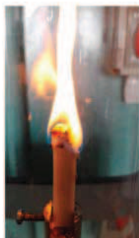
Rys. 5. Wartości indeksu tlenowego dla polipropylenu (PP), z napełniaczem w postaci talku 15% (PP T15), 20% (PP T20), 30% (PP T30) oraz talku 20% z uniepalniaczem (PP T20 V0) oraz próbka podczas spalania kominie do badań Fig. 5. The values of index oxygen of polypropylene (PP), filled of talc 15% (PP T15), 20% (PP T20), 30% (PP T30) and talc 20% with flame retardant (PP T20 V0) and the sample during combustion in the test chimney
