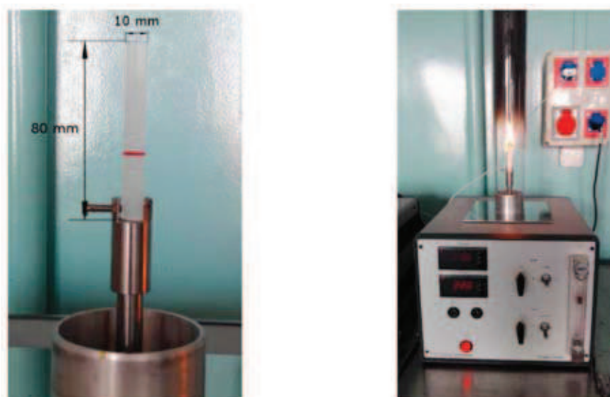
Rys. 3. Widok uchwytu próbki oraz urządzenie podczas testów
