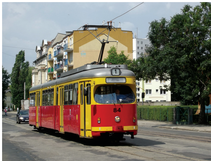
Grudziądz, ul. Dworcowa. GT8 84 z Krefeld otrzymał w Grudziądzu półowkowy pantograf OTK-2 (29.06.2013 r.) Fot. M. Witkowski
