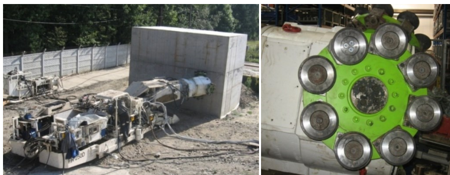
Rys. 10.11 Widok kombajnu chodnikowego typu RH250 z nową głowicą z narzędziami dyskowymi podczas prób urabiania
