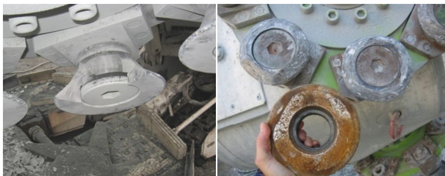
Rys. 10.14 Widok pękniętego, hartowanego narzędzia dyskowego ze stali narzędziowej NZZ oraz wytartych narzędzi dyskowych z żeliwa sferoidalnego ADI
