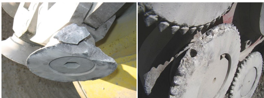
Rys. 10.13 Widok uszkodzonych narzędzi dyskowych: po lewej – mocowanych pod nieprawidłowym kątem, po prawej – zbrojonych słupkami z węglika spiekanego
