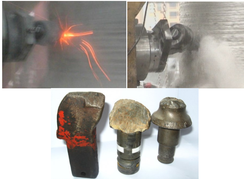
Rys. 10.2 Widok iskrzenia tarcowego i zapylenia podczas skrawania próbki skalnej nożem stycznie-obrotowym oraz zużycia ostrzy noży skrawających
