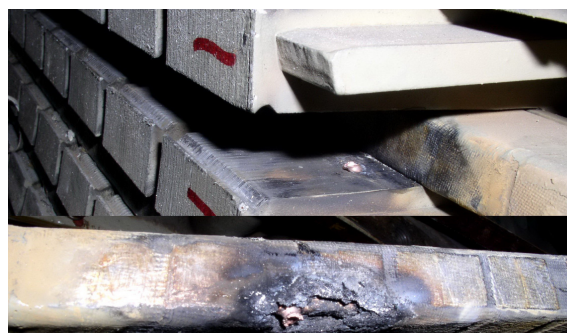
Rys. 11. Zwarcie cewki uzwojenia do rdzenia na wyjściu ze żłobka stojana
