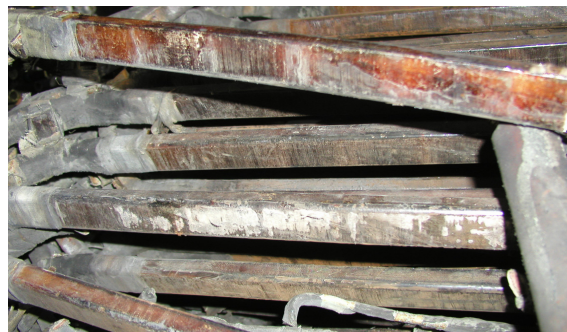
Rys. 8. Wytarcia izolacji głównej w żłobkach o ostre blachy rdzenia stojana
