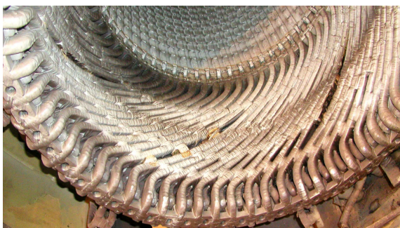
Rys. 13. Widok nieznacznych deformacja czoł
