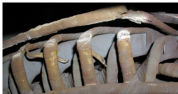
Rys. 9. Wzajemne wytarcie izolacji na połączeniach międzycewkowych i zasilających
