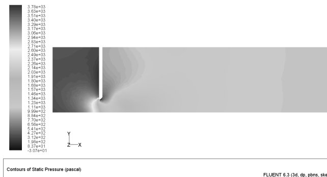
Rys. 4. Rozkład ciśnienia statycznego dla modelu 3D k-\varepsilon (dla kryzy segmentowej KS - 2 przy Re = 10\ 000 )
