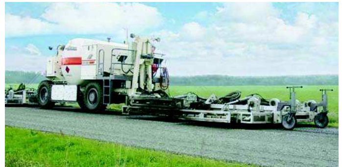
Fot. 1. Widok nagrzewnicy w promiennikami ciepła [13]
