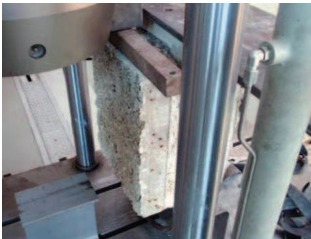
Rys. 2. Próbką w trakcie badań w maszynie wytrzymałościowej [6]
