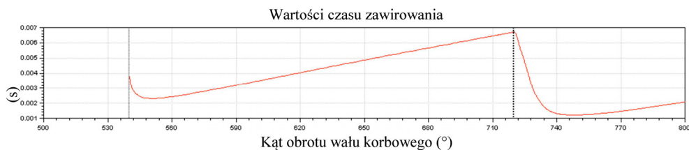
Rysunek 4. Wartości czasu zawirowania w funkcji kąta obrotu wału korbowego Figure 4. The values of turbulence time values as a function of crank angle
