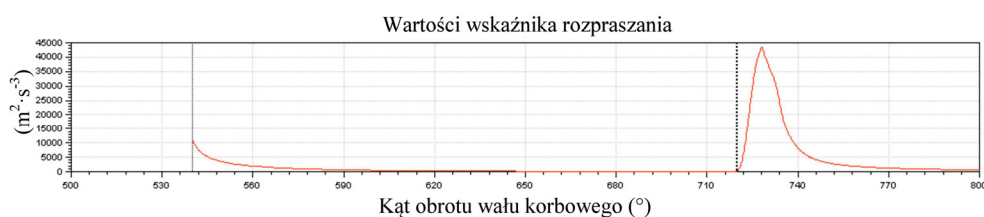
Rysunek 2. Wartości wskaźnika rozpraszania w funkcji kąta obrotu wału korbowego Figure 2. The values of the dispersion as a function of crank angle
