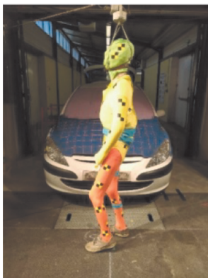
Ryc. 6. Zwłoki przygotowane do testów pełnej skali – potrącenie pieszego przez pojazd osobowy [22].
