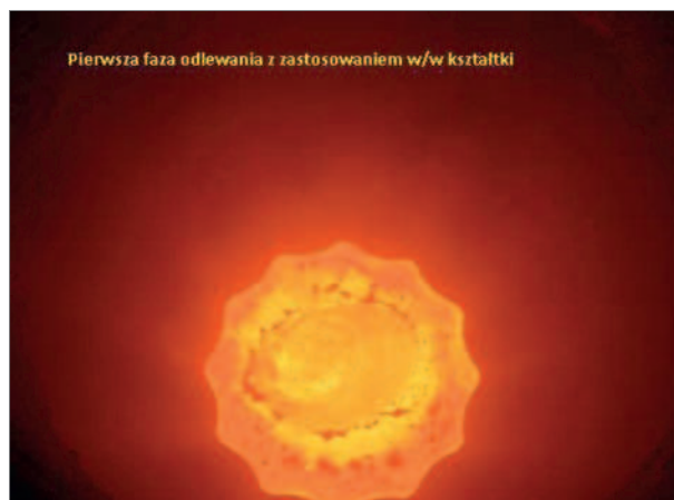
Rys. 8. Widok stali wpływającej do wlewnicy z zastosowaniem innowacyjnej kształtki kierunkowej
