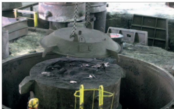
Rys. 12. Nakładanie pokrywy izotermicznej po odlaniu wlewków o masie 100 t
