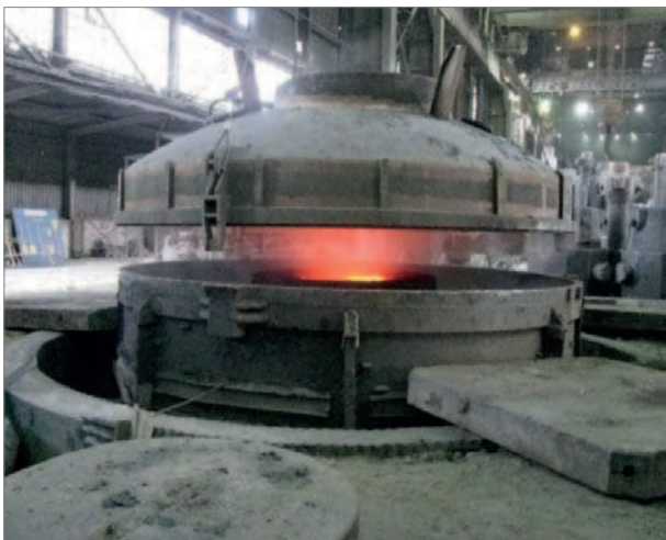
Rys. 11. Zdejmowanie pokrywy komory próżniowej wlewków po odlaniu
