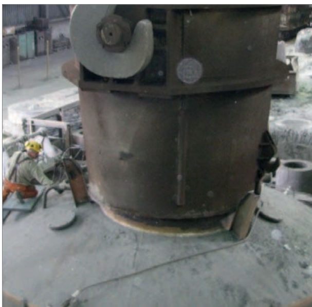
Rys. 10. Widok kadzi posadzonej na pokrywie komory próżniowej przy odlaniu wlewków o masie 75 Mg
