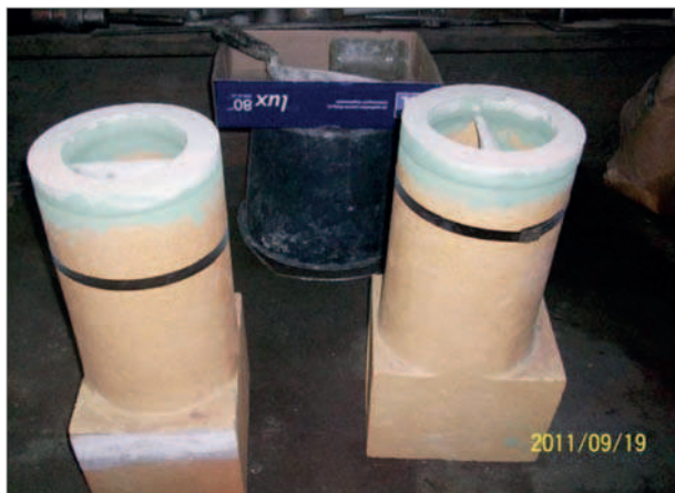
Rys. 6. Widok kształtek końcowych z kształtkami wirowymi i pierścieniami oporowymi
