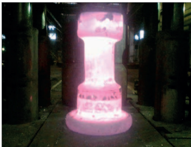
Rys. 14 Odkuwka bezpośrednio po kuciu wału turbiny gazowej z wlewka o masie 18 t odlanego sposobem syfonowym z zastosowaniem kształtki kierunkowej
