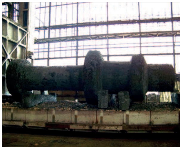
Rys. 13. Odkuwka wału turbiny wodnej wykonana z wlewków o masie 130 Mg odlanych w próżni
