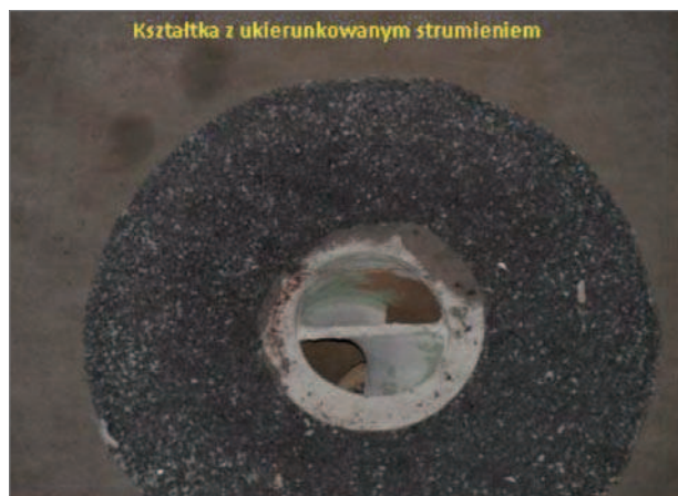
Rys. 7. Widok kształtki wirowej w zestawie syfonym przed odlewaniem
