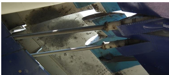
Rys. 1. Aktuatory z przekładnią śrubowo toczną sterujące położeniem klap w samolocie transportowym IŁ-76
