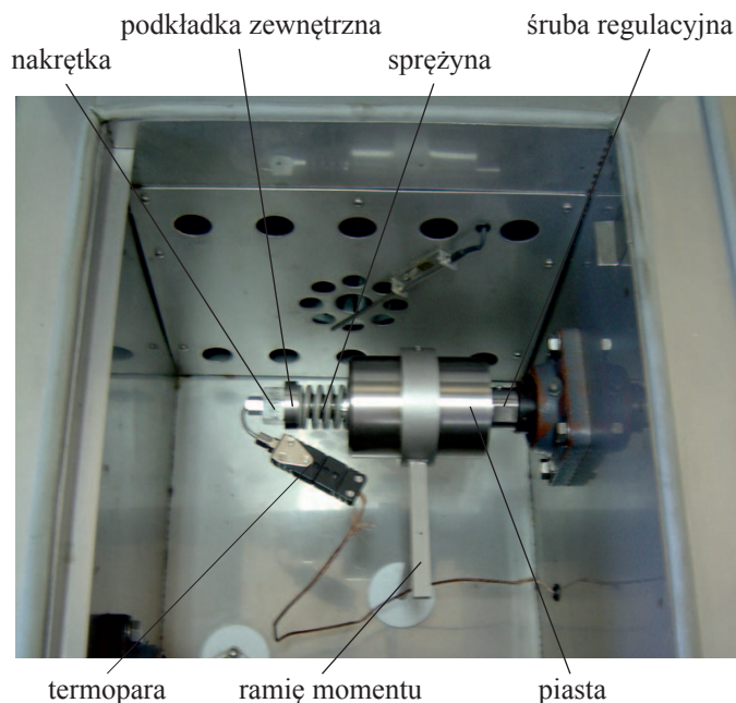
Rys. 3. Widok zespołu testowego stanowiska do badania momentu obrotowego według ASTM D 4693 (ITWL)
