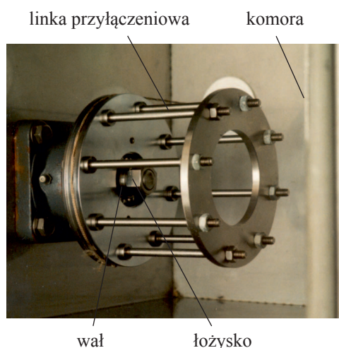
Rys. 2. Widok zespołu testowego stanowiska do badania momentu obrotowego według ASTM D 1478 (ITWL)
