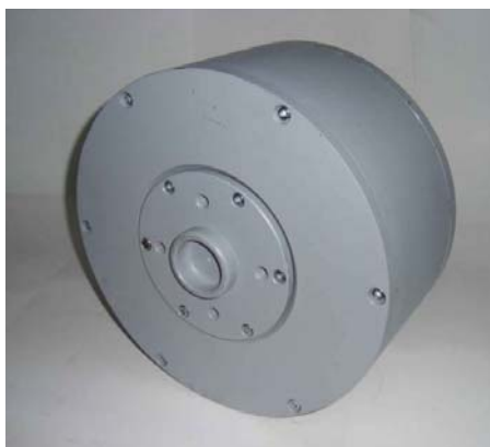
Rys. 1. Kompletny silnik synchroniczny o budowie odwróconej:
