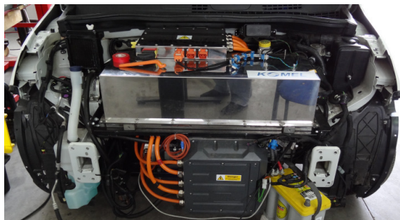
Rys. 1. Widok komory silnika zelektryfikowanego Fiata Panda z nbudowanym modulem bateryjnym
