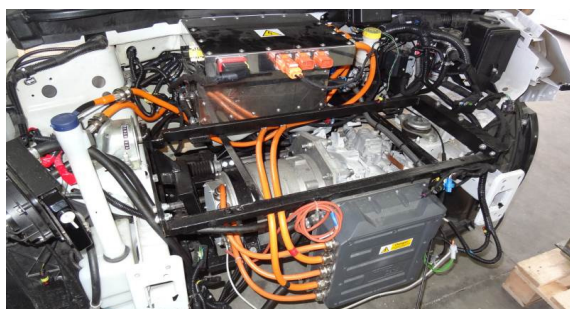
Rys. 2. Widok komory silnika zelektryfikowanego Fiata Panda. Widoczne są silnik IPMSM, falownik oraz skrzynia biegów
