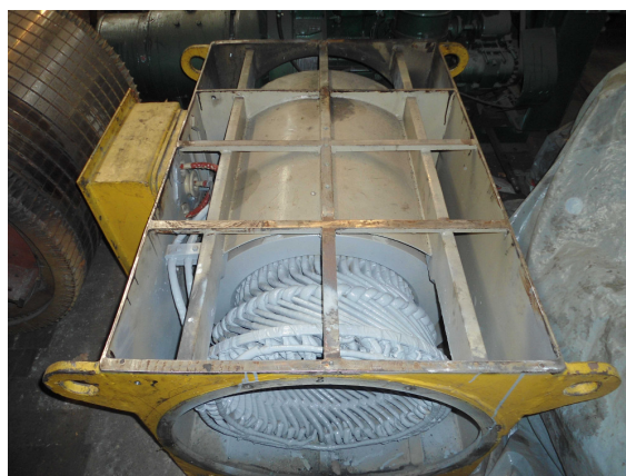
Rys. 3. Widok stojana uszkodzonego silnika po wyjęciu wirnika do naprawy
