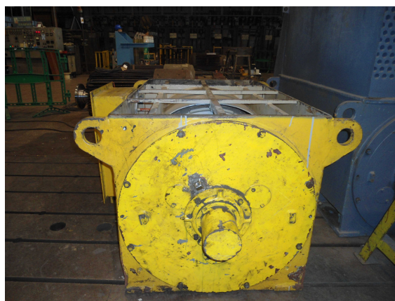
Rys. 2. Widok silnika z uszkodzeniem 6 prętów klatki rozruchowej, badanego podczas eksperymentu na stacji prób
