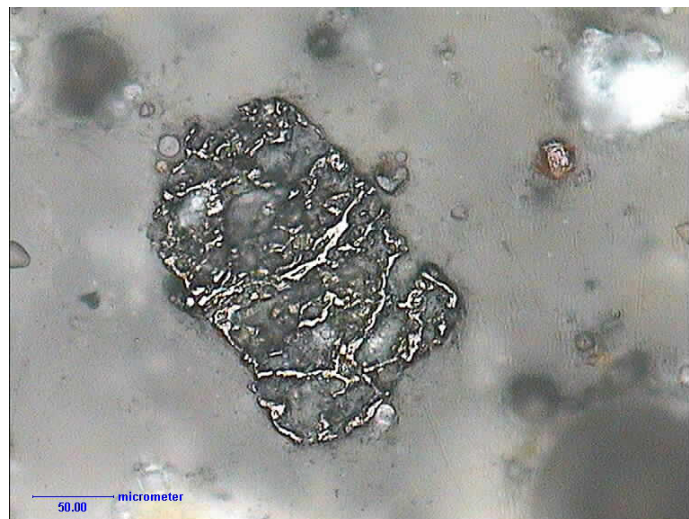
Fot. 3. Niespalona materia organiczna w formie sieci, klasa ziarnowa 0,125–0,09 mm. Światło odbite, pow. 200×
