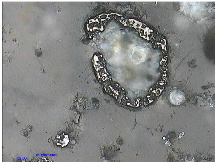
Fot. 1. Niespalona materia organiczna w formie cenosfery, próbka popiołu surowego. Światło odbite, pow. 200×
