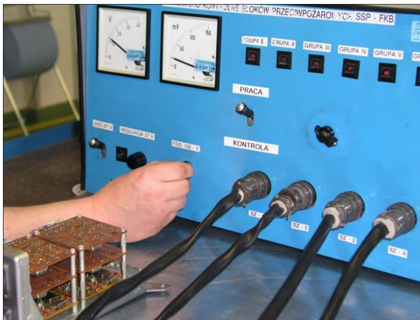
Rys. 14. Stanowisko do badań systemu w warunkach spadku napięcia zasilania [4]
