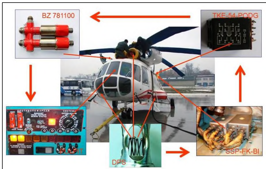
Rys. 2. Schemat sposobu generacji sygnału pożaru przez system SSP-FK na śmigłowcu Mi-8 [4]
