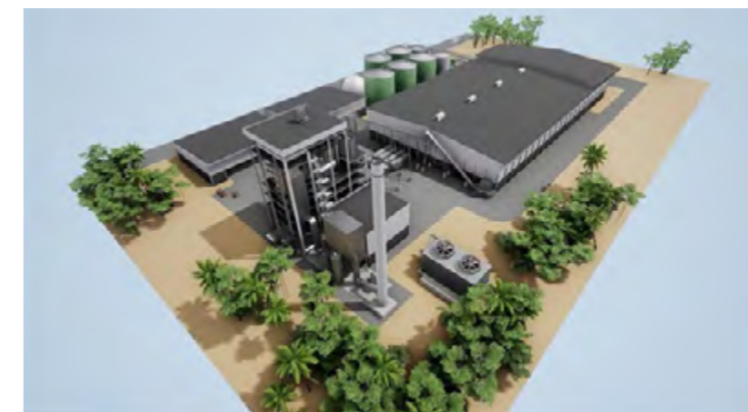
Prezentacja przestrzeni zajmowanej przez modułową elektrociepłownię Valmet o mocy 10 MWe wraz z instalacją do produkcji RDF i instalacją AD
