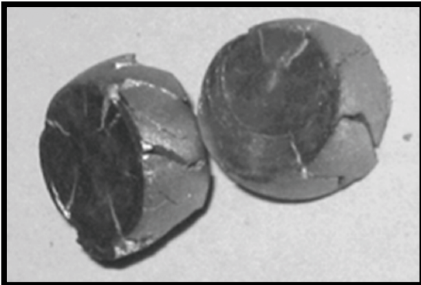
RYS. 2. Przykładowe próbki spieków po ściskaniu. FIG. 2. Exaple of compressed samples.
