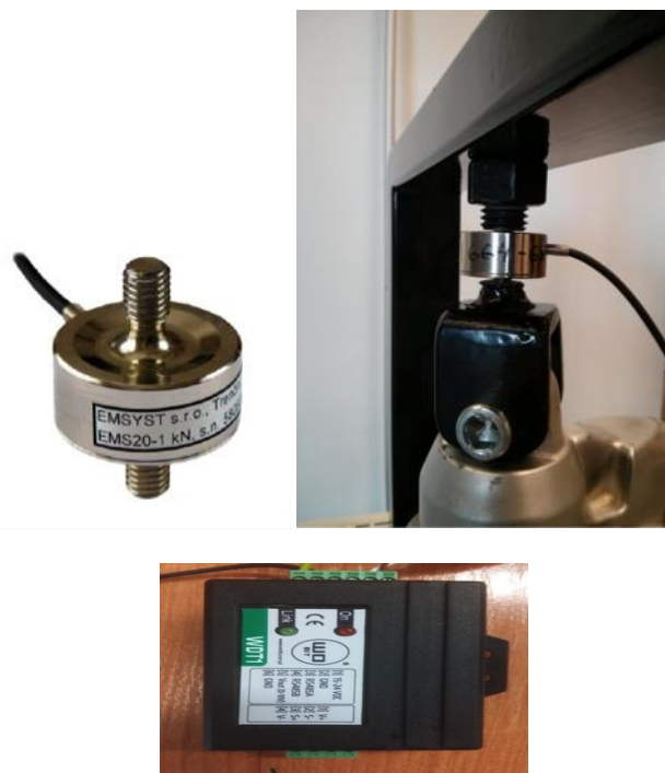
Rys. 2. Część pomiarowa stanowiska (tor pomiaru siły tłumienia): usytuowanie oraz mocowanie czujnika siły KMM20-2kN i zewnętrzny układ mostkowy WDT1
