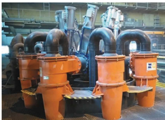
Rys. 3. Hydrocyklony o średnicy 500 mm, produkcji IMN - Zanam Fig. 3. Hydrocyclones 500 mm, manufactured by IMN - Zanam
