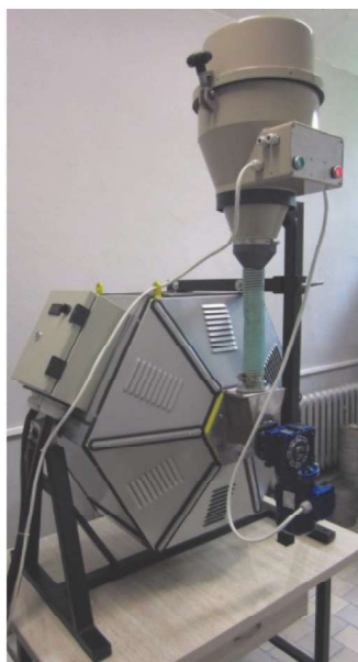
Rys. 4. Młyn elektromagnetyczny i schemat instalacji młyna Fig. 4. Electromagnetic mill and mill installation diagram
