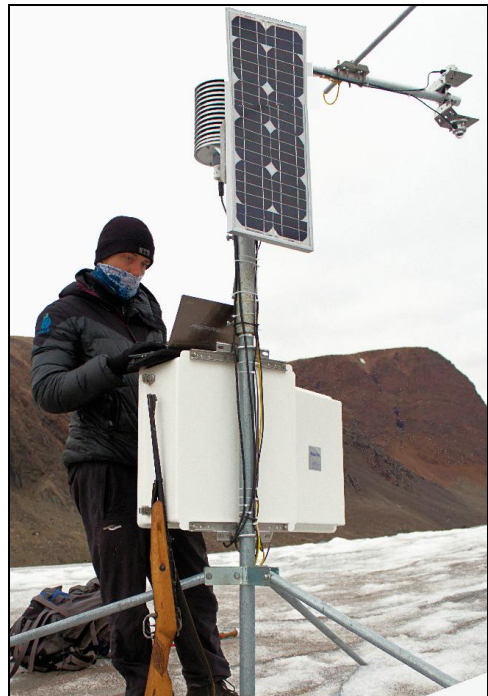
Fot. 3. Tymczasowy posterunek meteorologiczny na lodowcu Sven (fot. Archiwum)
