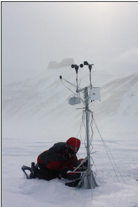
Fot. 2. Tymczasowy posterunek meteorologiczny na lodowcu Pollock (fot. G. Rachlewicz)
