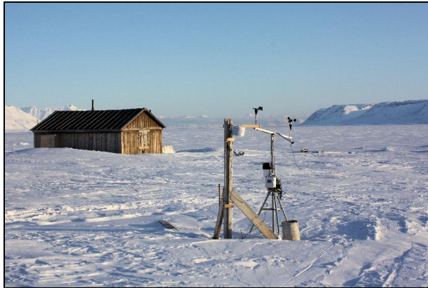
Fot. 1. Stały posterunek meteorologiczny przy Skottehytta na wschodnim wybrzeżu Zatoki Petunia (fot. G. Rachlewicz)
