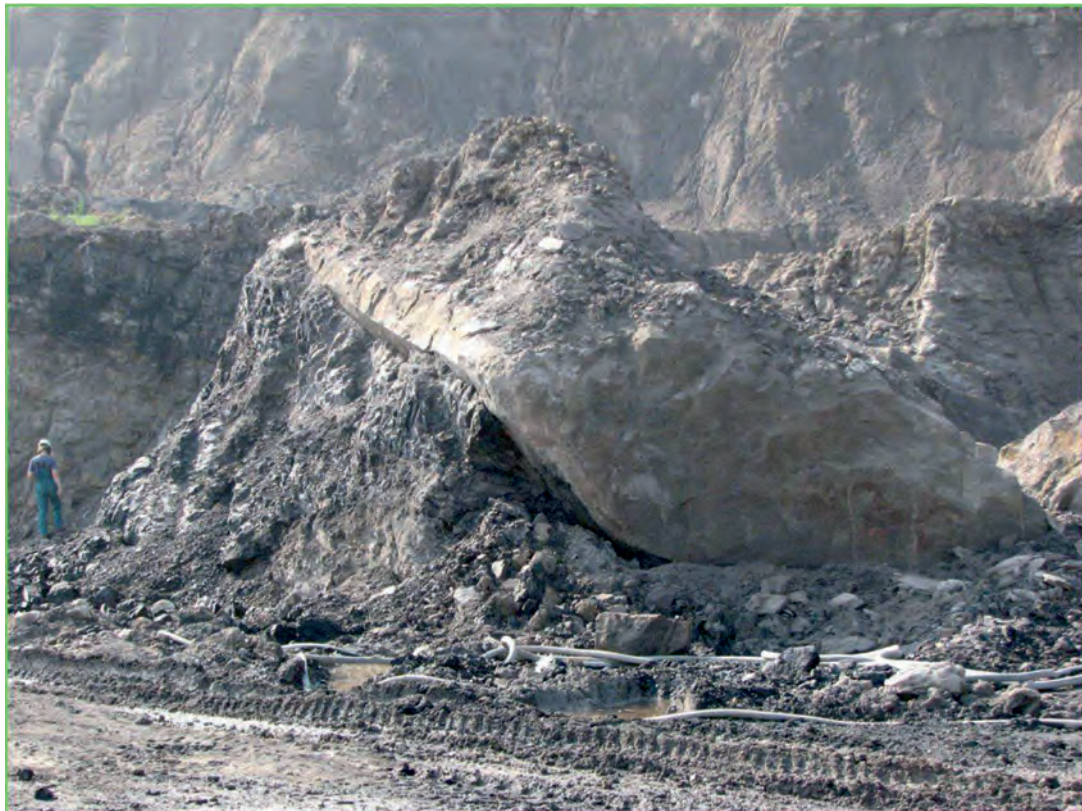
Fig. 3. Boulder of sandstone with dolomite cement Rys. 3. Głaz piaskowcowy ze spoiwem dolomitowym
