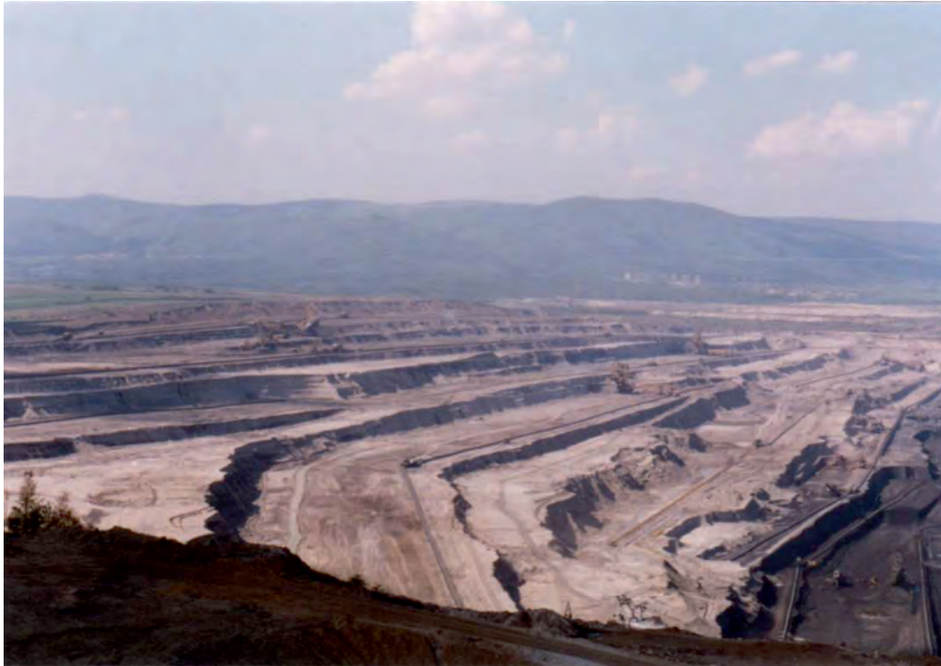
Fig. 2. The Bilina Mine – situation of the overburden cuts Rys. 2. Kopalnia Bilina – piętra nadkładowe
