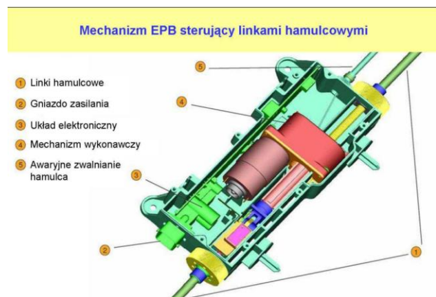
Rys. 6. Budowa mechanizmu EPB [3]
