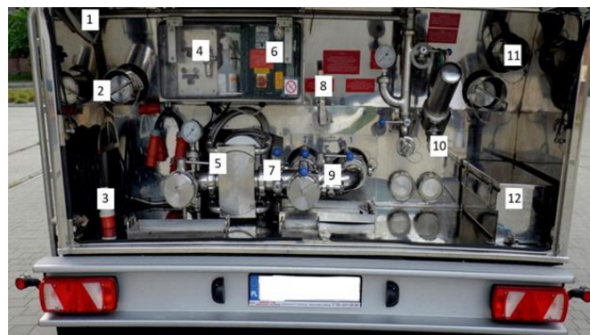
Rys. 2. Skrzynia rozładunkowa cysterny spożywczej z widocznym osprzętem; 1 – wygarniaczka, 2 – wąż rozładunkowy, 3 – kabel zasilający pompę i przejściówka, 4 – sterownik systemu pozwalającego na wyrównywanie ciśnienia w cysternie bez manualnego otwierania włazów, 5 – pompa, 6 – sterownik pompy, 7 – kolektor, 8 – zawór denny, 9 – zawory spustowe, 10 – filtr sterylności, 11 – węże rozładunkowe, 12 – skrzynia na złączki
