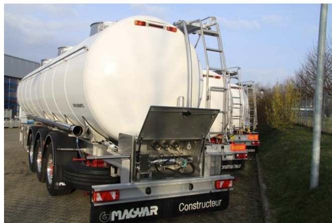
Rys. 1. Cysterny spożywcze marki Magyar z widoczną w skrzyni rozładunkowej pompą krzywkową
