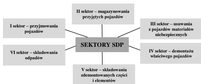
Rys. 1. Sektory stacji demontażu pojazdów
