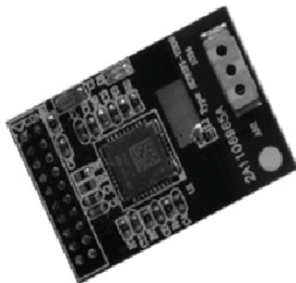
Rys. 1. Przykład badanego modułu Wi-Fi którego praktyczny zasięg wynosi 15m (moduł rozszerzający SD Wi-Fi do systemów FriendlyARM)
