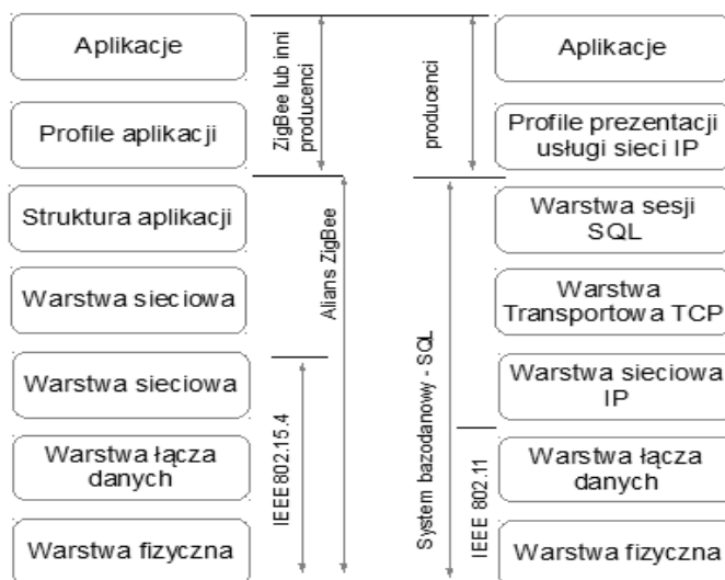
Rys. 4. Modele sieci sensorycznych (po lewej stronie rysunku sieć IEEE802.15.4 i ZigBee, po prawej sieć Wi-Fi i Intranet z bazą danych SQL)
