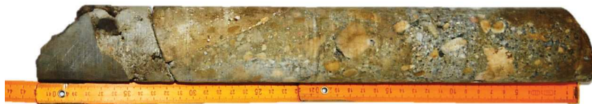
Rys. 7. Widok rdzenia pobranego z obmurza szybu w rejonie poziomiu II Fig. 7. Core taken from the shaft lining at the level II
