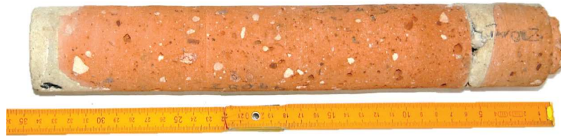
Rys. 5. Widok rdzenia pobranego z obmurza szybu ok. 10 m poniżej zrębu Fig. 5. Core taken from the shaft lining about 10 m below the shaft outset
