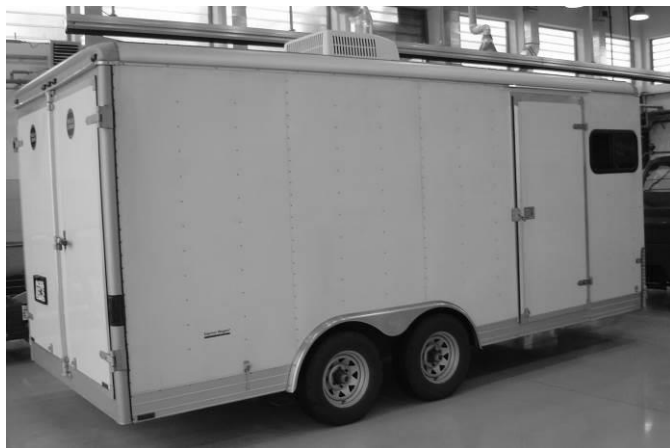
Rys. 7. Przykład przyczepy Grupy HRT do transportu pokładowego zbiornika hydrazynowego w kontenerze
