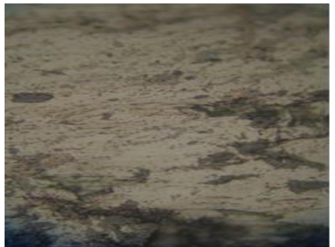
Rys. 25. Powierzchnia tarcia po współpracy dla obciążenia 700 N przy prędkości 300 obr/min, przy powiększeniu: x500
