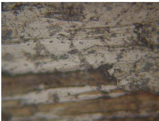
Rys. 27. Powierzchnia tarcia po współpracy dla obciążenia 1000N przy prędkości 300 obr/min, przy powiększeniu: x500
