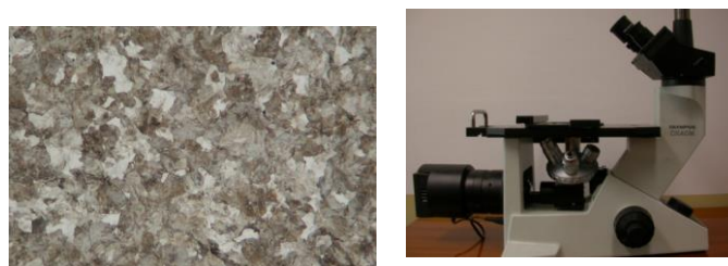
Rys. 6. Zgląd metalograficzny próbki wykonanej ze stali bainitycznej Rys. 7. Mikroskop metalograficzny firmy Olympus CK40M
