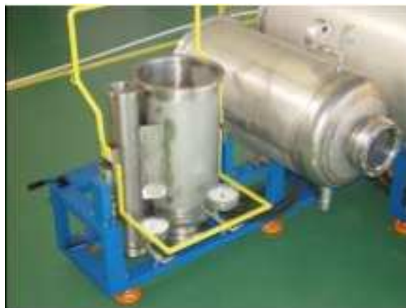
Ryc. 10. Stanowisko do badania narzędzi pneumatycznych: a) system zasilania wodą, b) rury testowe wychylne
