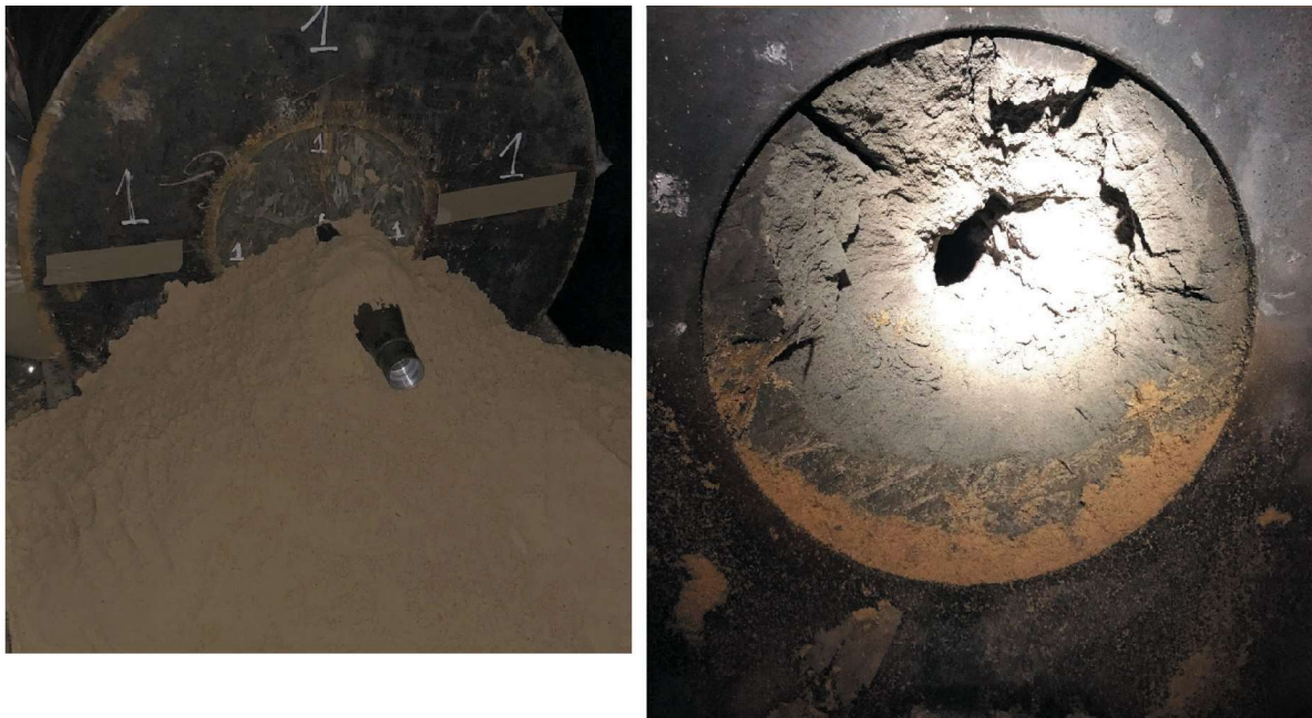
Rys. 7. Widok bloku cementowego w obudowie stalowej z przyłożoną głowicą kumulacyjną (po lewej) oraz jego powierzchnię czołową po detonacji ładunku kumulacyjnego Fig. 7. View of a cement block in the steel casing with the shaped charge warhead (left) and its front block surface after shaped charge detonation (right)
