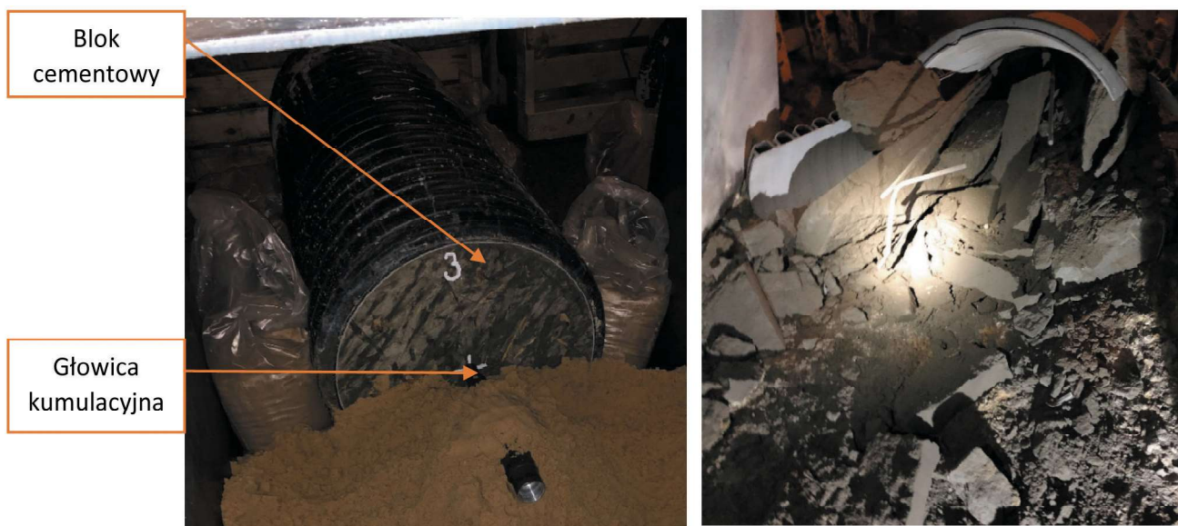
Rys. 5. Widok bloku cementowego z przyłożoną głowicą kumulacyjną (po lewej) oraz sfragmentowanego bloku cementowego po detonacji głowicy PG-7M (po prawej)
