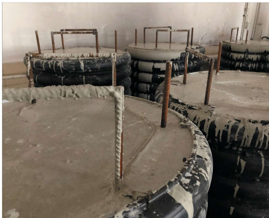
Rys. 4. Przygotowane bloki cementowe w osłonie z prętami zbrojonymi Fig. 4. Prepared cement blocks in housing with reinforcement bars
