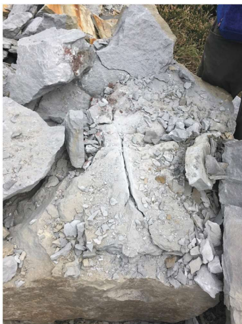
Rys. 2. Zdjęcie bloku skalnego po detonacji głowicy PG-7M Fig. 2. View of the rock block after the detonation of the PG-7M warhead
