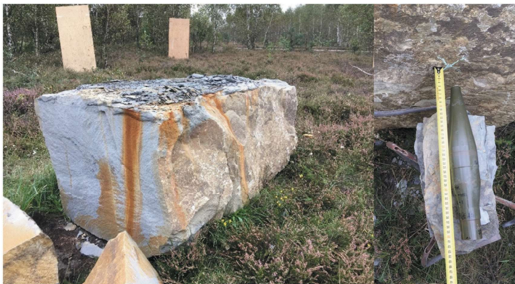
Rys. 1. Zdjęcie bloku skalnego oraz sposób pozycjonowania głowicy PG-7M Fig. 1. View of a rock block and the placement method of the PG-7M warhead
